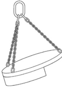
Bild 15: Der Großteil der Last wird von zwei Kettensträngen getragen
